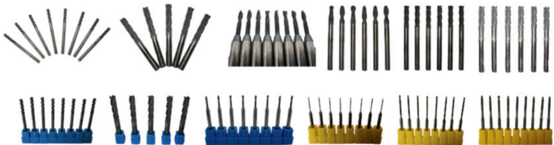
图 5-3 无锡职业技术学院博士研发的 CAD 硼参杂金刚石涂层在复杂形状刀具上的应用
